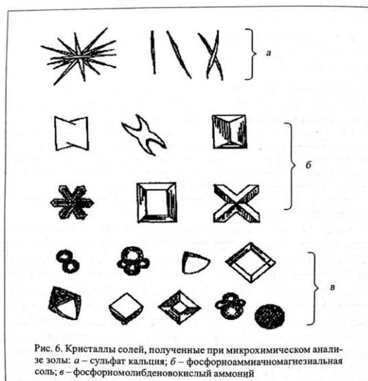
Для обнаружения магния к капле испытуемого раствора следует сначала добавить каплю раствора аммиака, а затем соединить канальцем с реактивом, которым служит 1%-ный раствор фосфорнокислого натрия. Образуется фосфоаммиачномагнезиальная соль (см. рис.), кристаллизующаяся в виде прямоугольников, крышечек, звезд или крыльев в результате следующей реакции:
